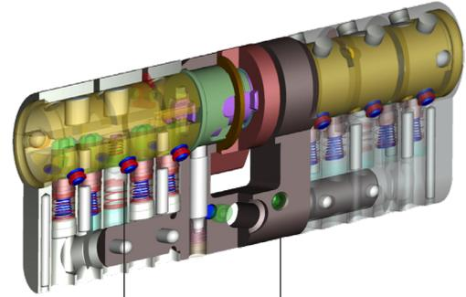
Trap Pin / blocage du rotor
