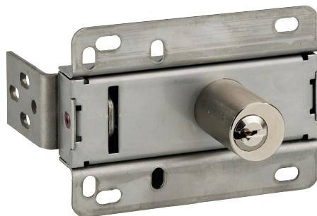
Les serrures d'accès sont utilisées sur des portes, des trappes, des accès ou des têtes débrochables de transformateurs. Spécialement conçues pour ce type d'applications, la clé est prisonnière tant que l'accès est ouvert. Seule sa fermeture, garantie par l'introduction de la gâche dans la serrure, permet la libération de la clé.
